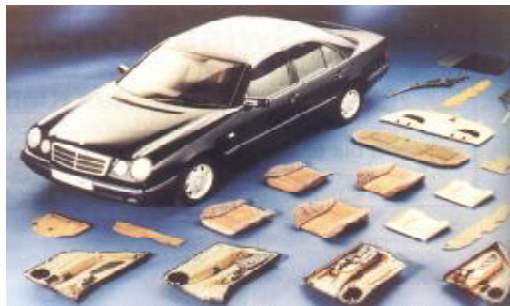
Bild 1 Beispiele für Bauteile im PKW aus naturfaserverstärkten Kunststoffen /DaimlerChrysler/
